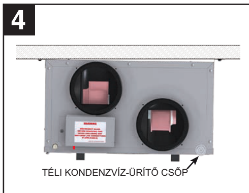
4. ábra Kondenzvíz-ürítő konfiguráció
